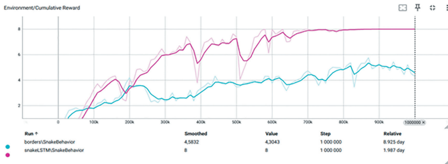
Рис. 6. Порівняльний графік TensorBoard сумарної винагороди при навчанні моделей PPO та PPO+LSTM
