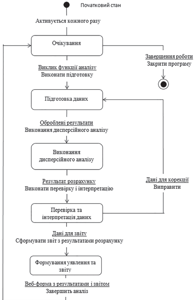
Рис. 6. Діаграма станів для «ПК для обробки медичних даних з використанням дисперсійного аналізу»
