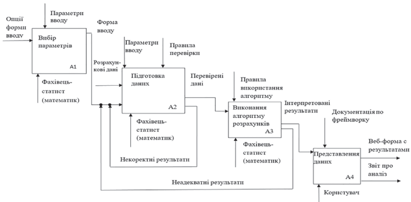
Рис. 2. Деталізуюча структурно-функціональна SADT – діаграма першого рівня для бізнес-процесу «Обробка медичних даних з використанням методів дисперсійного аналізу»
