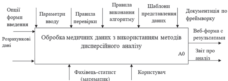
Рис. 1. Контекстна SADT-діаграма 0-го рівня бізнес-процесу «Обробка медичних даних з використанням методів дисперсійного аналізу»
